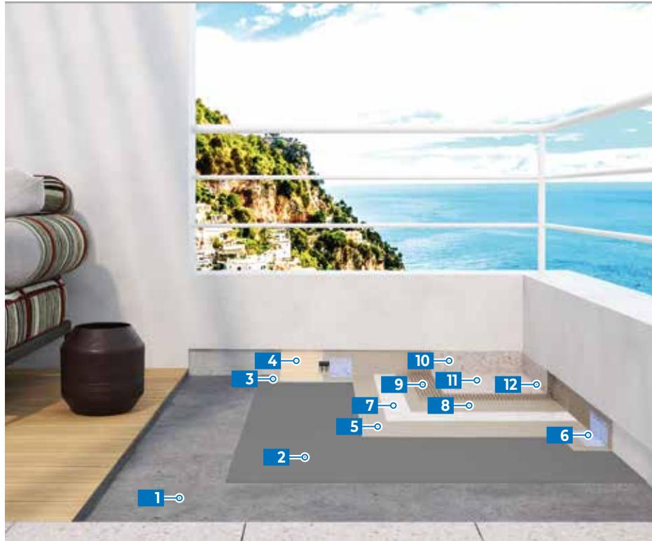
**1** Supporto cementizio esistente pulito, asciutto e meccanicamente resistente
